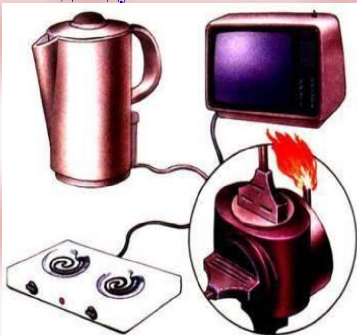
Перегрузка электропроводов kuhta.dan.su
